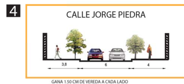
Figura 24. Esquema de Trazado Propuesto Fuente: Alumnos del Taller MET
