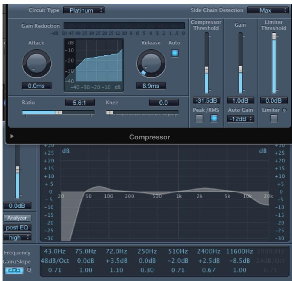
Figura 46. Procesamiento canal de batería mono
