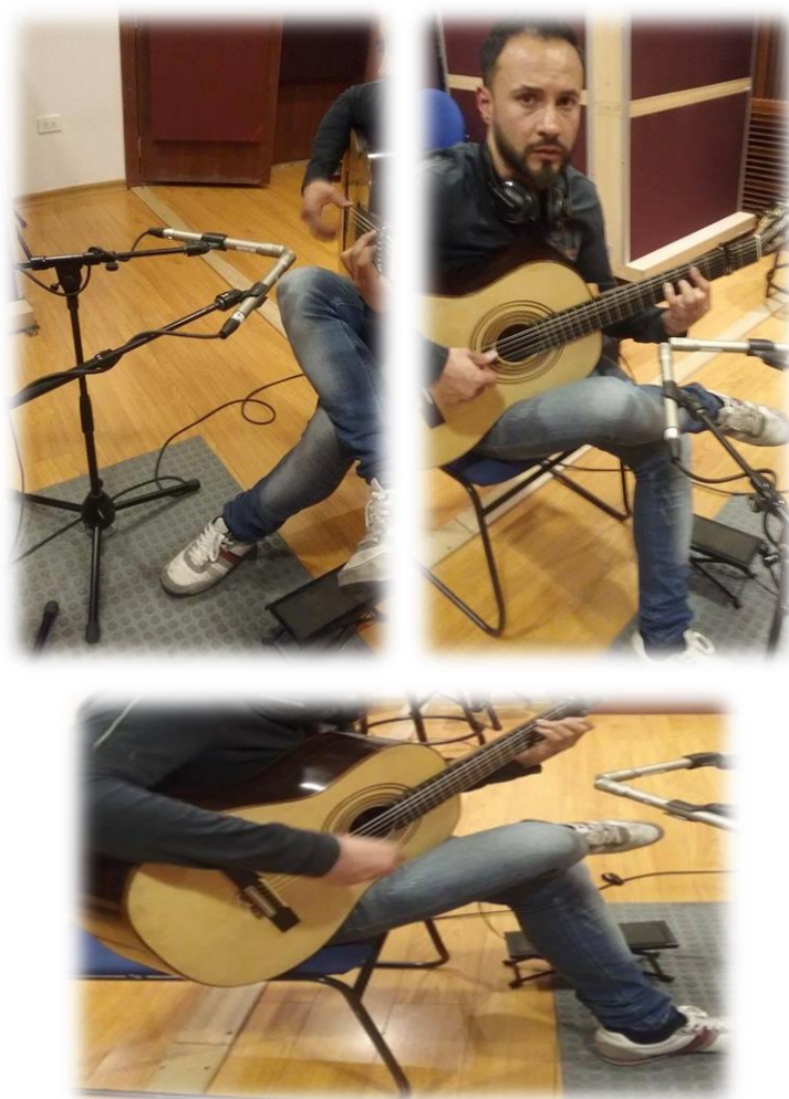
Figura 52. Colocación de micrófonos de la técnica estéreo par coincidente X/Y.
