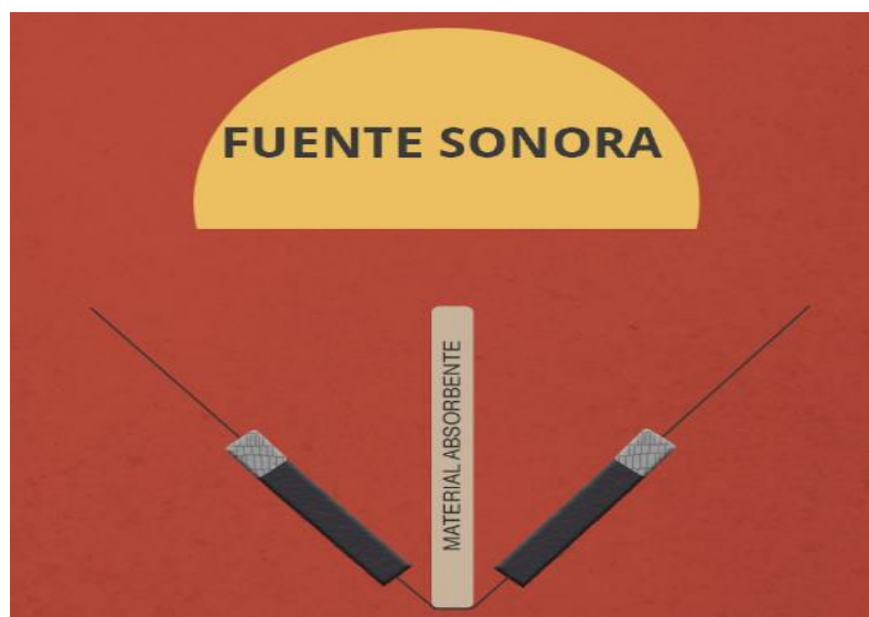
Figura 38. Técnica Disco de Jecklin.
