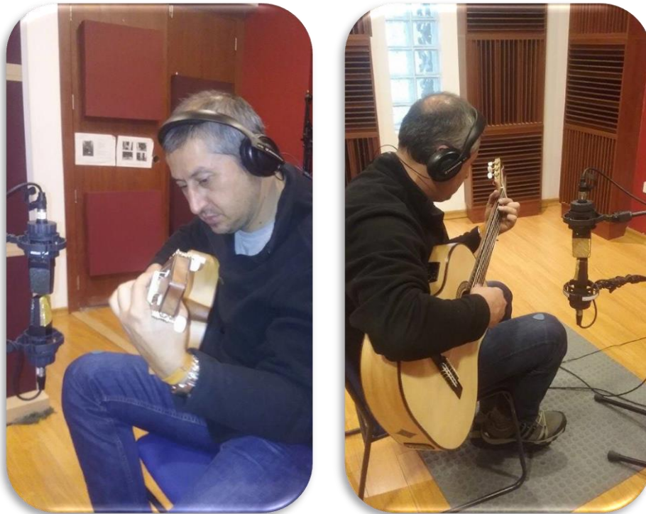
Figura 55. Colocación de micrófonos de la técnica estéreo por coincidente Blumlein Array.
