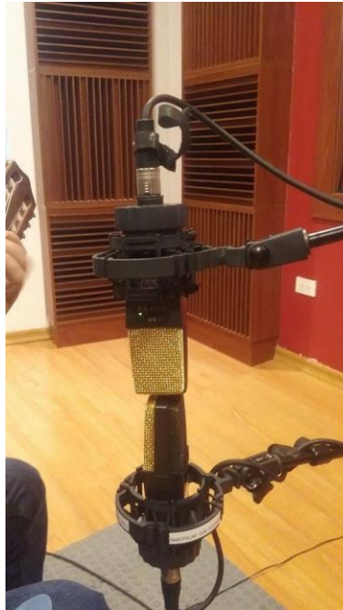
Figura 27. Configuración microfónica M-S.
