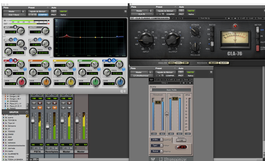
Figura 63. Cadena de procesamiento para la masterización.
