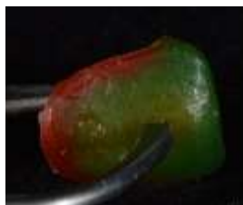
Figura 3. Encerado y colocación de revestimiento para la técnica de cera perdida.
