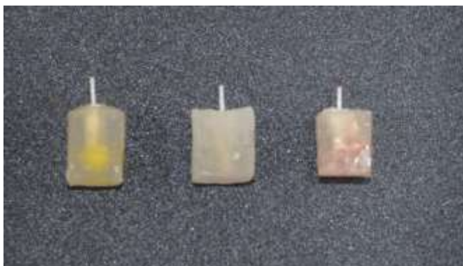
Figura 8. Bloques de Acrílico con raíces y pernos
