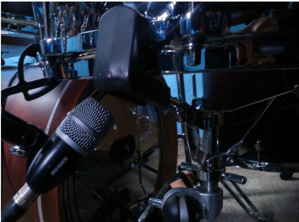
Figura 8: Micrófono Shure PG56-XLR ubicado en la parte inferior de la caja
