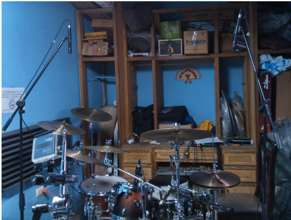
Figura 11: Ubicación de os micrófonos Shure PG81-XLR como overheads
