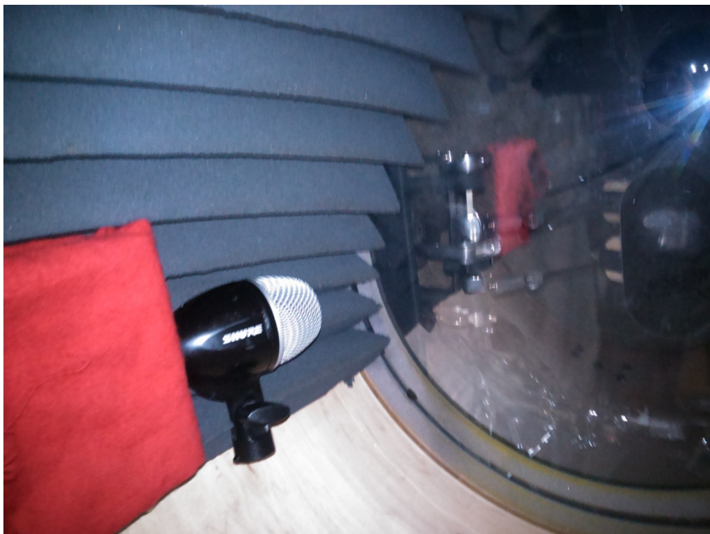
Figura 6: Micrófono Shure PG52-XLR, ubicado en la parte interna del bombo
