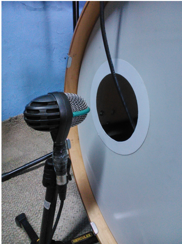
Figura 5: Micrófono Akg D112, ubicado en la parte externa del bombo
