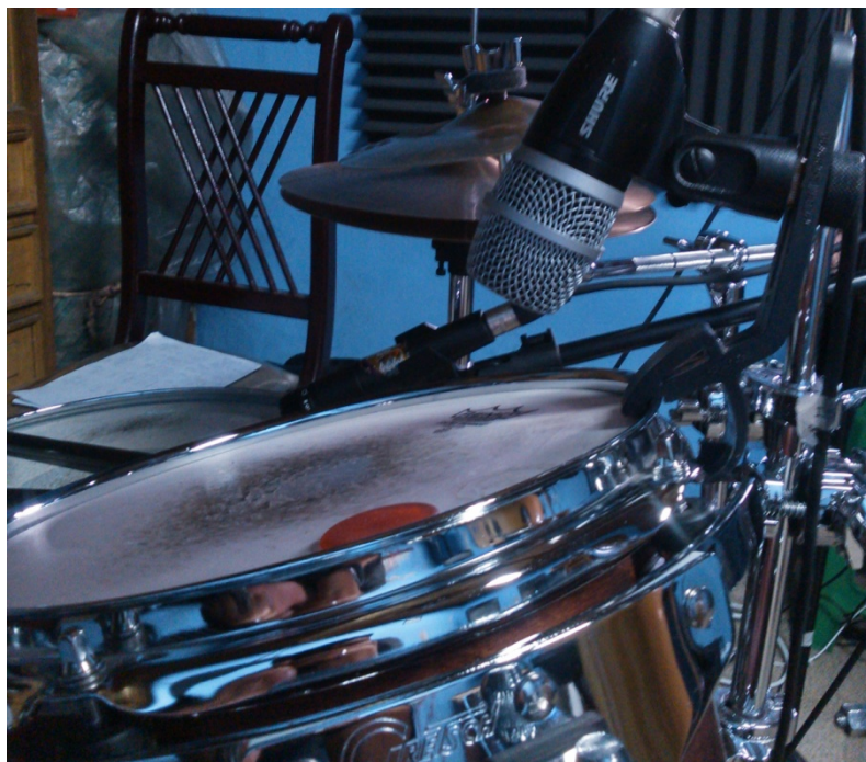
Figura 9: Micrófono Shure PG56-XLR ubicado en el Tom.
