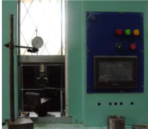
Figura 14. Maquina Universal de Ensayos, laboratorio de la universidad ESPE (Escuela politécnica del Ejercito).
