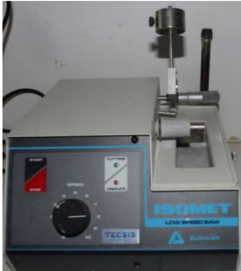
Figura 14. Máquina de corte de precisión Isomet Low Seed Saw
