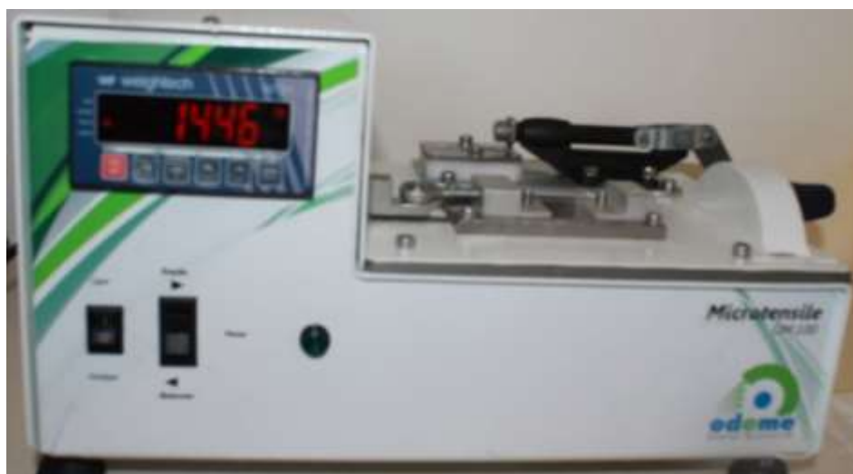
Figura 21. Máquina universal de ensayos de micro tracción
