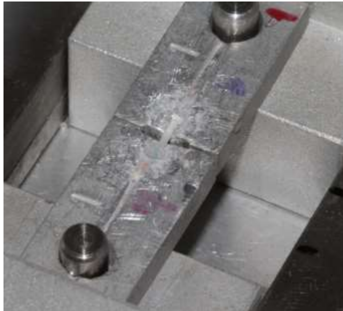
Figura 25. Cuerpo de prueba sometido a micro tracción
