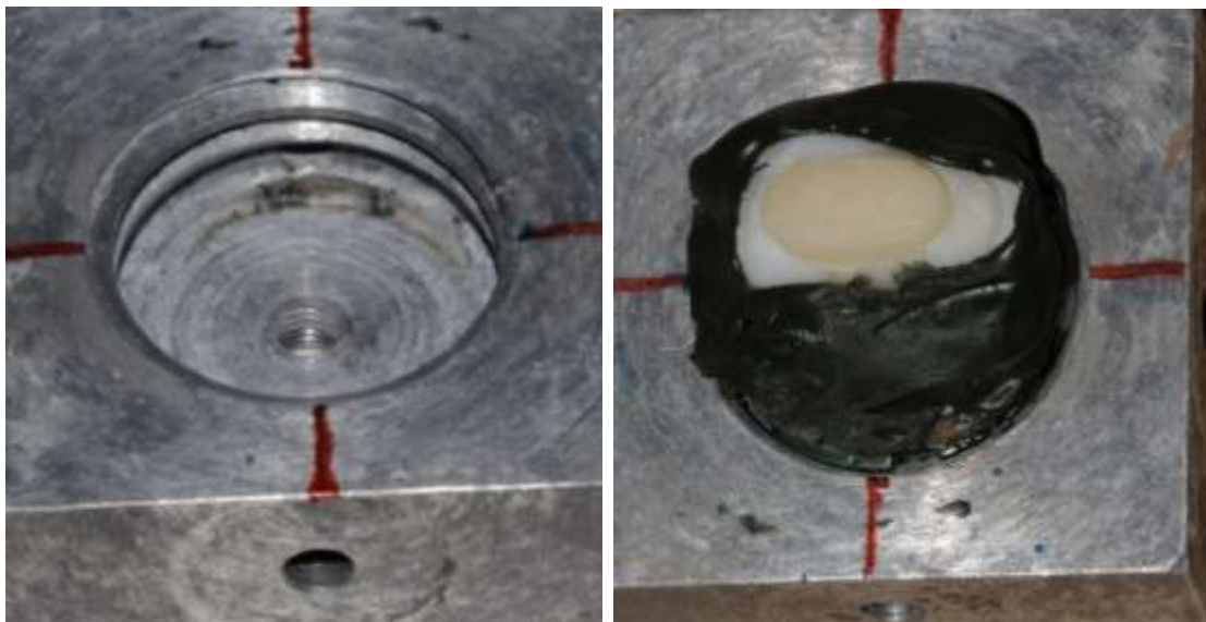
Figura 15. Porta muestras cuadrado y diente instalado
