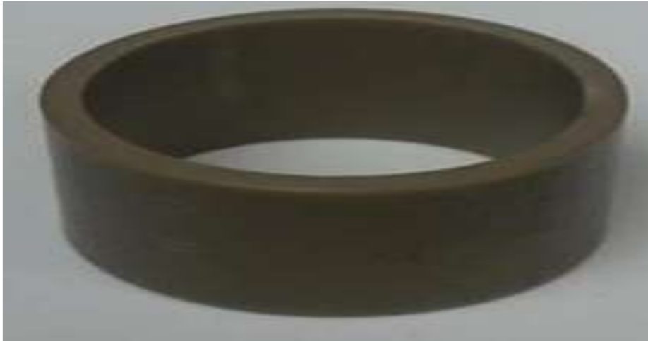
Figura 4. Cilindro sobre el cual se coloca el acrílico
