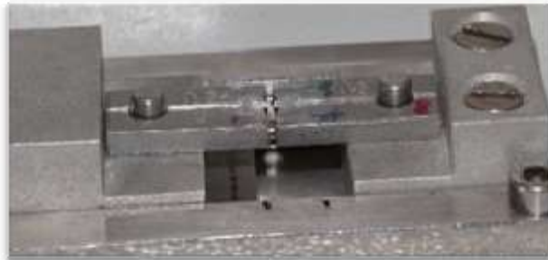
Figura 23. Traccionamiento de la muestra
