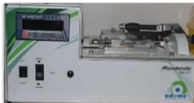
Figura 20. Máquina de Microtracción (Microtensile OM 100; Odeme Dental Researc)
