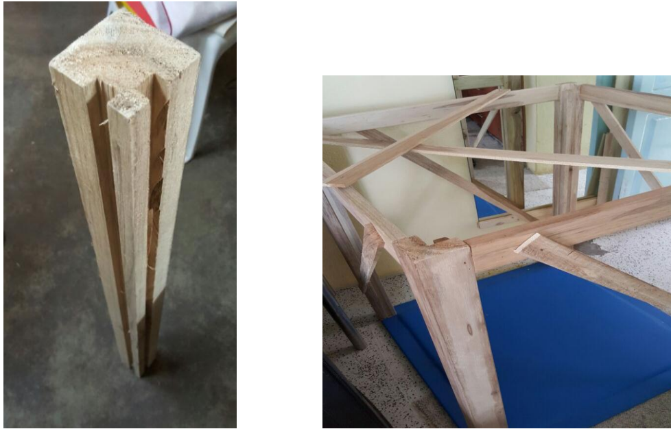
Figura 56: Construcción de sistema de canales en prototipo final.
