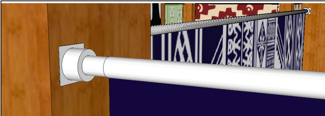
Figura 73. Soportes de cortina ensamblados a las columnas
