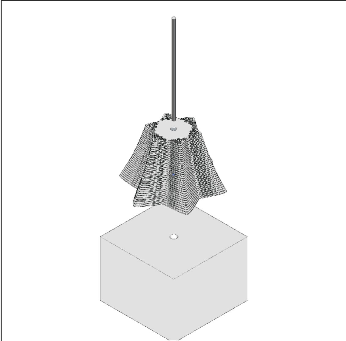
Figura 58. Explosión de los componentes de la escultura kinética
