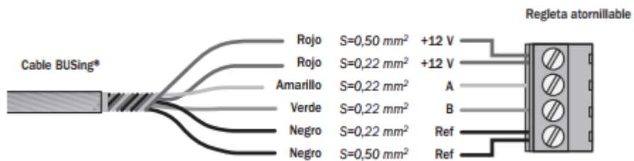
Figura 25. Conectorización de cable Busing.
