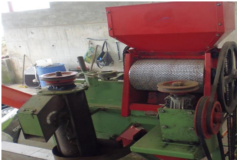
Figura 9. despuladora con desmicilaginador electrica.
