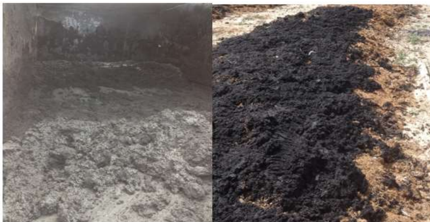
Figura 21. Lodo residual inicial y armado de camas
