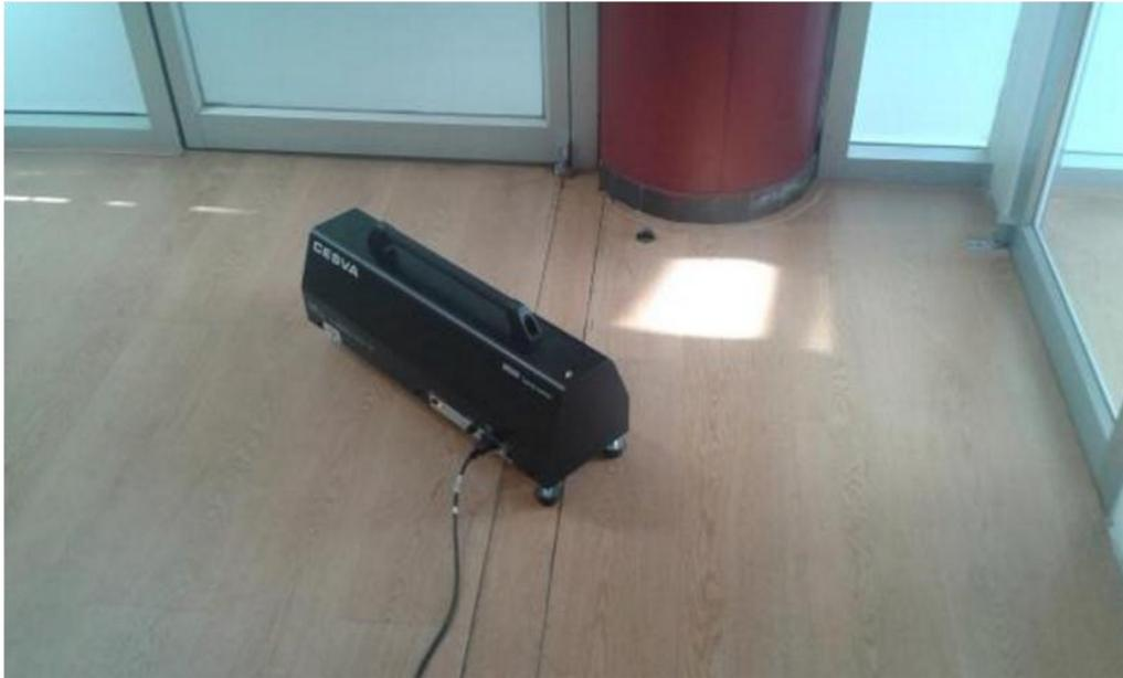
Figura 40. Máquina de impactos *Cesva MI006* ubicada a 45° con respecto a las vigas.
