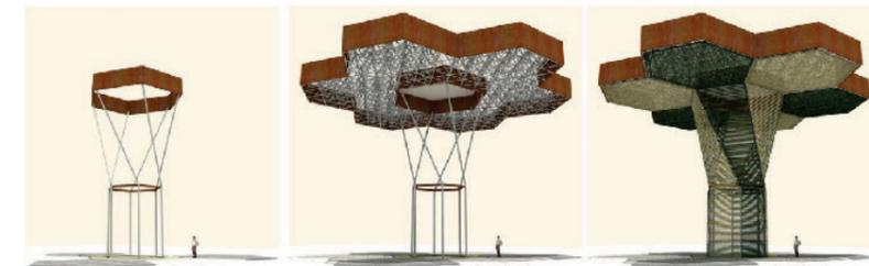
Estructura metálica hexagonal y modular que al unirse con un mismo elemento forma un conjunto que funciona como una sola unidad.
