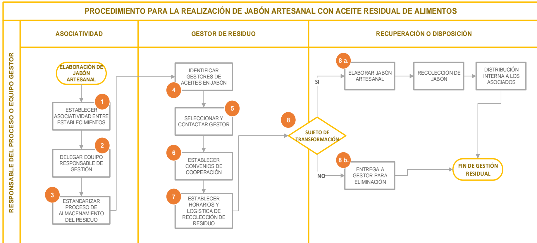
Figura 2. Diagrama de flujo para gestionar el residuo con la elaboración de jabón artesanal.
