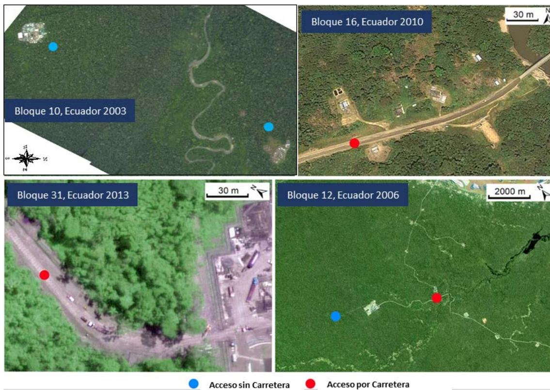
Figura 4. Fotos aéreas de plataformas de perforación por acceso terrestre y heli-transportable de diferentes bloques en el Ecuador
