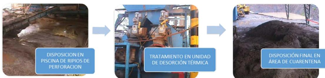
Figura 33. Diagrama de procesos para el manejo de los Rípios de perforación desde su disposición inicial hasta el proceso de Desorción Térmica
