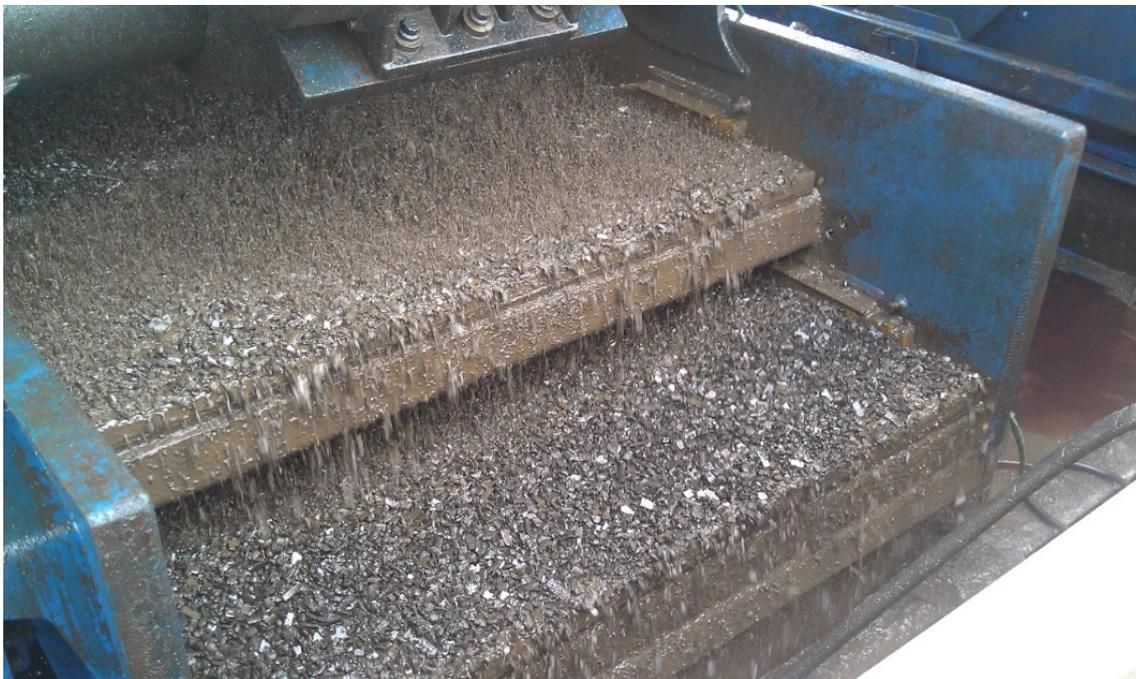
Figura 12. Cortes de perforación generados y receptados en las zarandas superficiales
