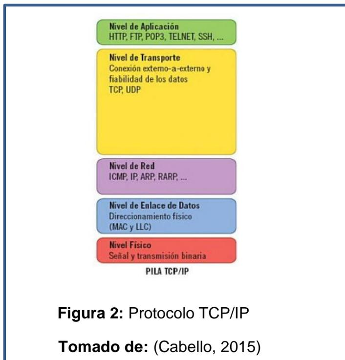
Observando en la figura 2, las características principales del protocolo TCP/IP como estándar para las conexiones en Internet.
