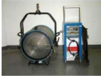
*Figura 23.* Luz HMI de 6K junto a su balastro.
