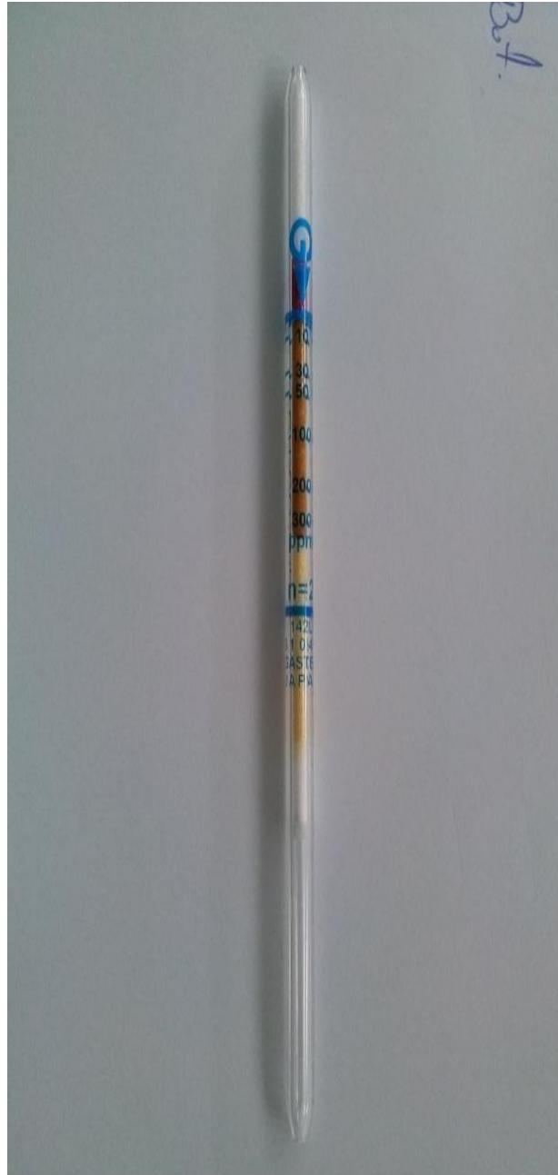
Figura 35: Tubo colorimétrico Acetato de butílo marcando 300 ppm
