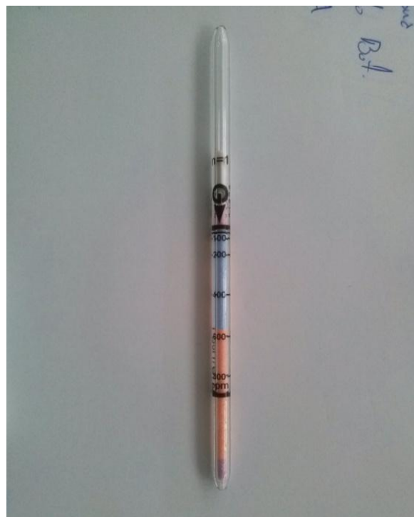
Figura 37: Tubo colorimétrico Alcohol Isopropílico marcado 560 ppm
