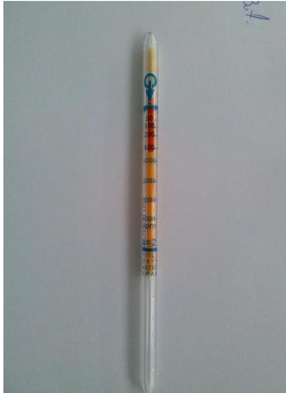
Figura 36: Tubo colorimétrico Acetona marcando 530 ppm
