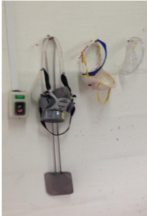
Figura 38: Equipos de protección personal en mal estado.
