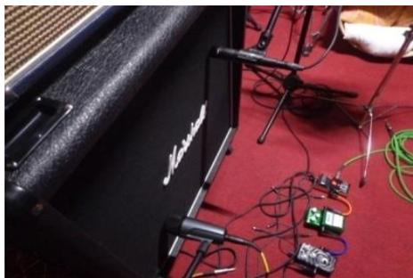
Figura 7. Microfonía guitarra eléctrica con distorsión.
