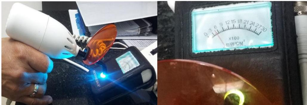
**Figura N°8: Calibración de la lámpara de luz halógena resultado 500  $\text{mW}/\text{cm}^2$**
