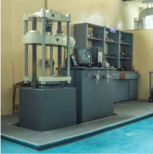
Figura 16. Máquina Universal de Ensayos. Modelo Tinius Olsen Súper L120.
