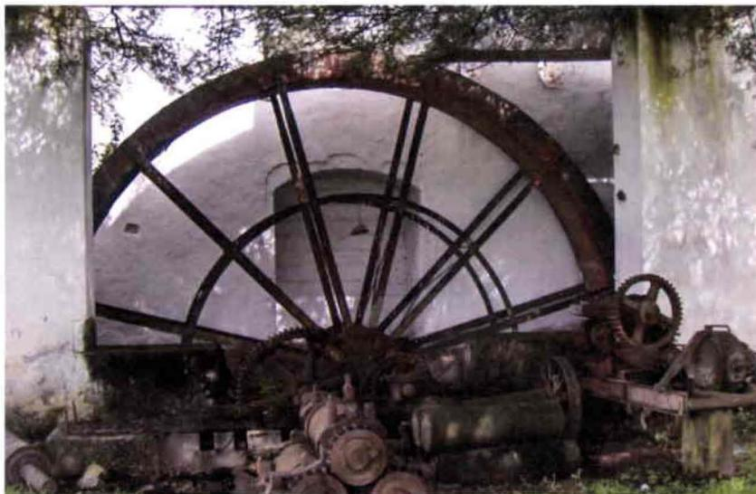
Se destaca en una de éstas edificaciones la presencia de un Álabe; rueda hidráulica que con la fuerza del agua servía para generar energía eléctrica para los trapiches y la fábrica de alcohol; ésta pieza de importancia se ha convertido en un elemento emblemático del lugar por el grado visual que tiene ésta en la fachada de una de las edificaciones.
