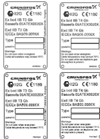
Fig. 3 Placas de homologación de las bombas antideflagrantes, clasificaciones T3 y T4
