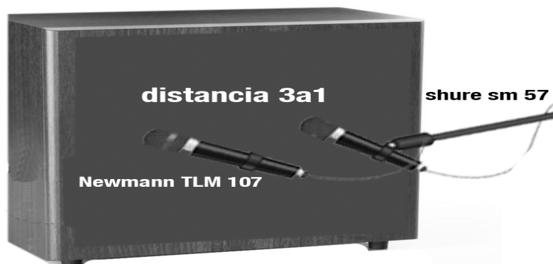
Figura 12. Ubicación de los micrófonos en un amplificador
