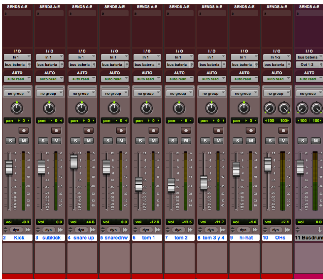
Figura 26. Ejemplo de ruteo de una batería a un canal auxiliar
