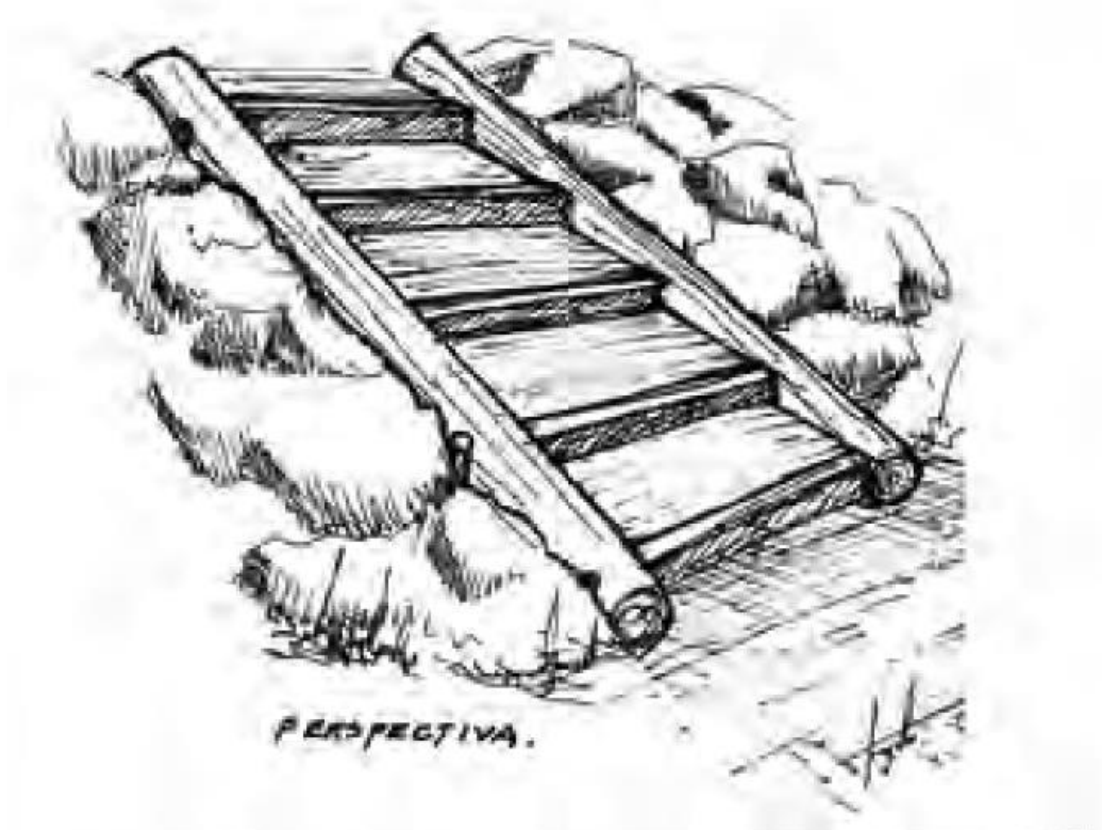
Figura 4. Gradas en el Sendero, vista diagonal
