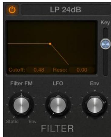
*Figura 21. Filtro de paso de bajos (low pass filter).*
