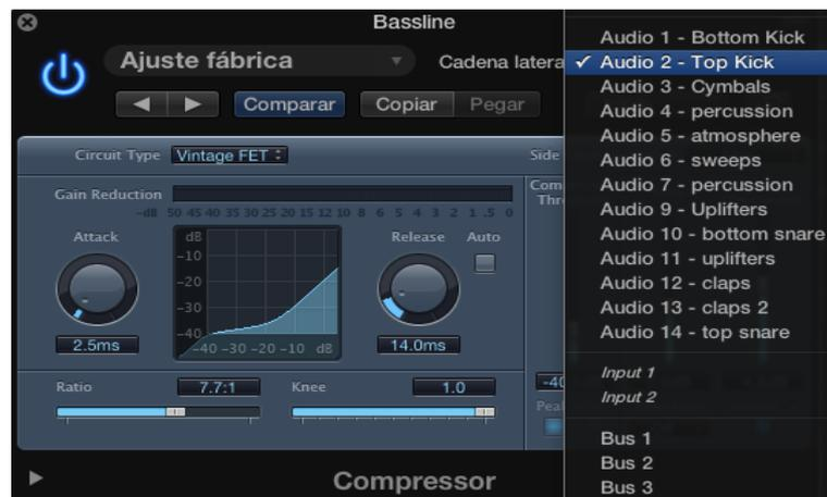
Figura 38. Envío de señal mediante sidechain.
