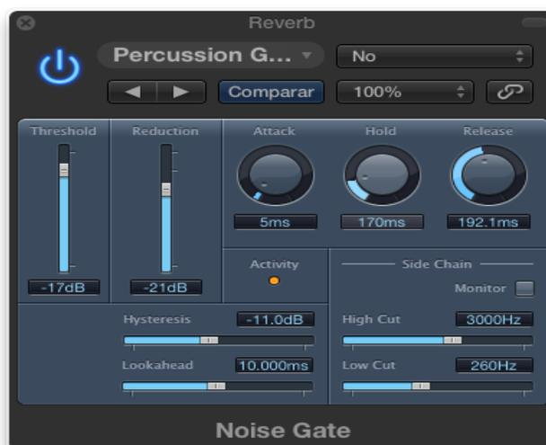
Figura 76. Noise Gate. Tomado de Logic Pro X
