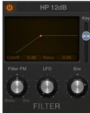
Figura 22. Filtro de paso de altos (high pass filter).
