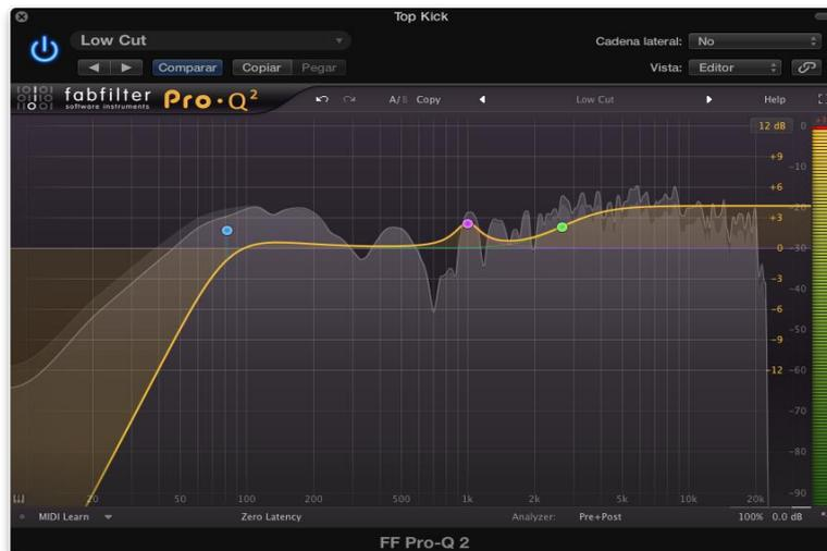
Figura 58. Configuración final ecualización Top Kick.
