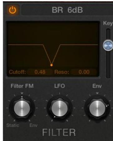
Figura 24. Filtro de rechazo de banda (notch filter o band reject filter).
