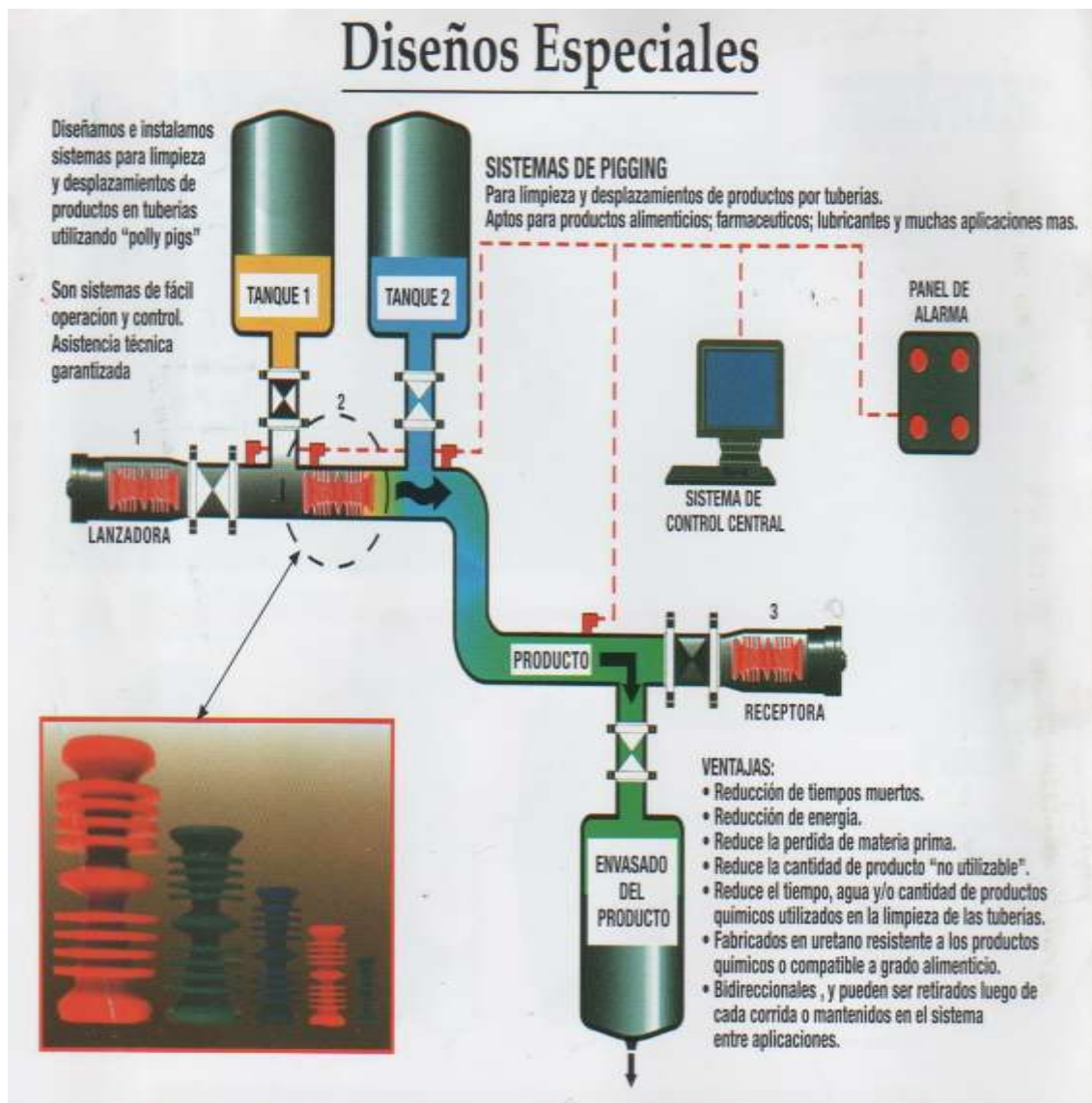
Figura 4. Instalación de Pigs Tomado de (Girardind, s.f.)
