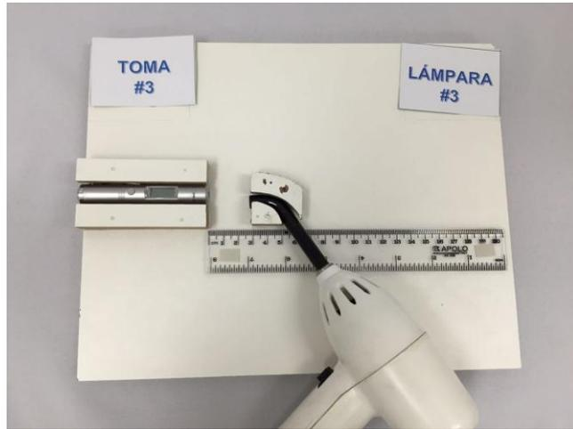
*Imagen 7.* Toma de Temperatura con Termómetro Digital a 3 cm
