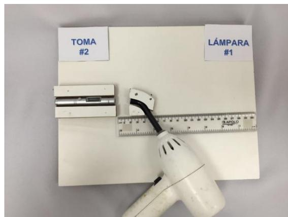
*Imagen 4.* Toma de Temperatura con Termómetro Digital a 2 cm
