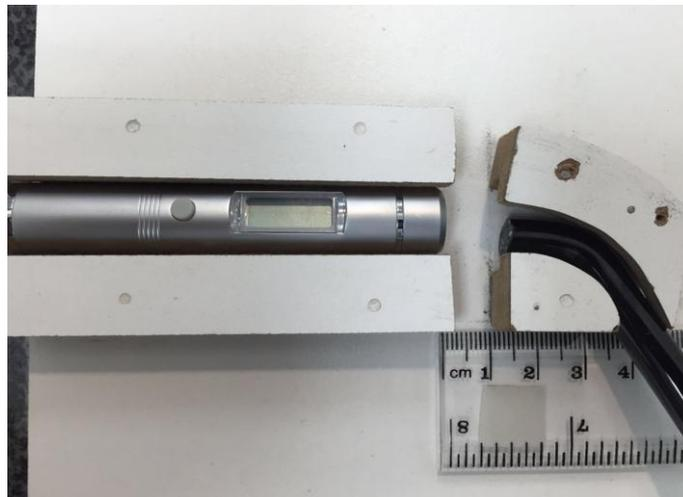
*Imagen 2.* Toma de Temperatura con Termómetro Digital a 1cm
