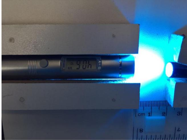
*Imagen 5.*Toma de Temperatura con Termómetro Digital a 2 cm
