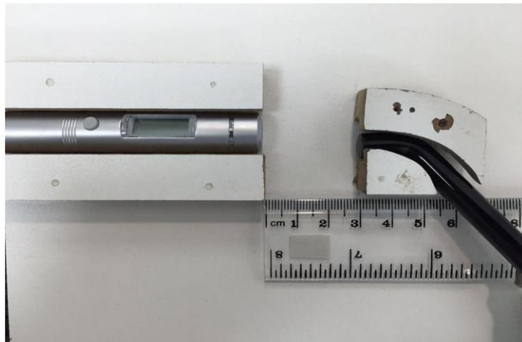
*Imagen 8.* Toma de Temperatura con Termómetro Digital a 3 cm
