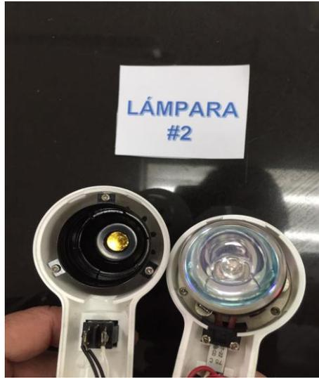
*Imagen 13. Análisis del filamento del foco y filtro*
