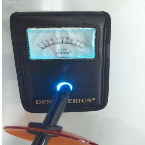
*Imagen 11. Medición de la Intensidad de Luz con Radiómetro
