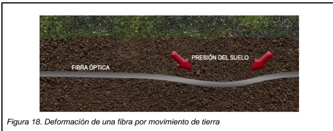
Como se observa en la Figura 18, al ocurrir un movimiento de tierra produce una curvatura o estrés en el cable de fibra óptica. Esto produce una reflexión en el pulso de luz que envía el OTDR cuando se realiza mediciones. Con esta reflexión producida se puede calcular la distancia en la que ocurrió el evento. A mayor perturbación mayor será la atenuación de la señal. (Salinas, 2003)
