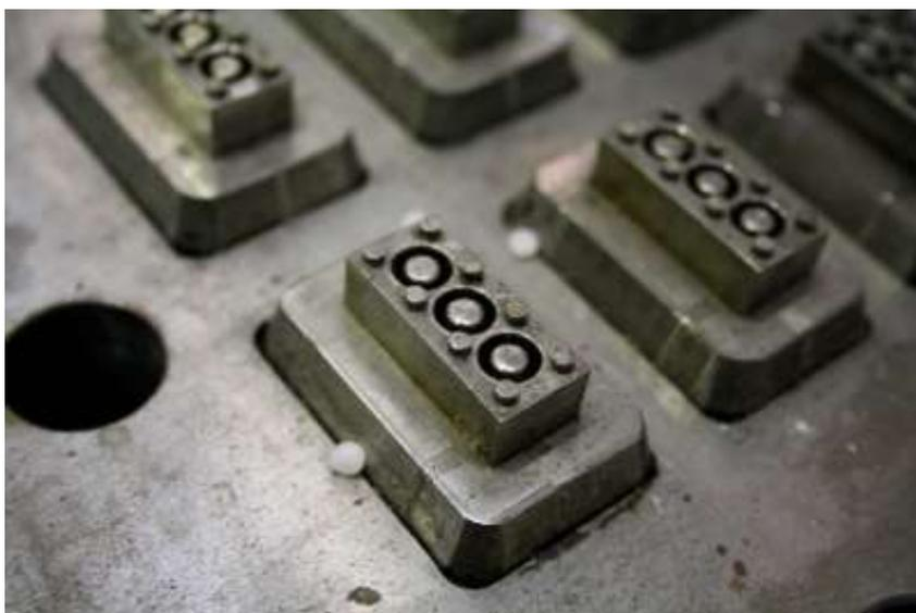
Figura 40. Moldes para la fabricación de piezas de lego mediante inyección.
