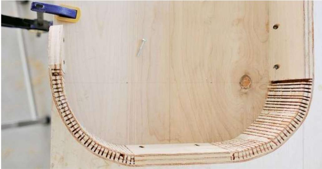
Figura 73. Ejemplo de *Kerf Bending*.
