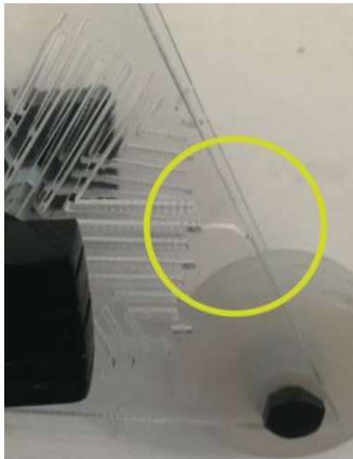
Figura 62. Fracturas en el acrílico.
