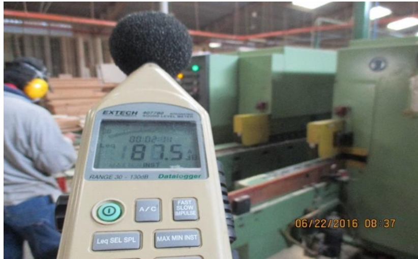
Figura 16: Instalación de Sonómetro.
