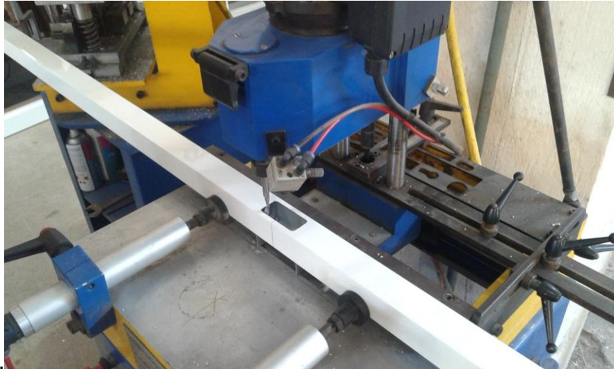
Figura 30: Colocación de anclas en el tubo
