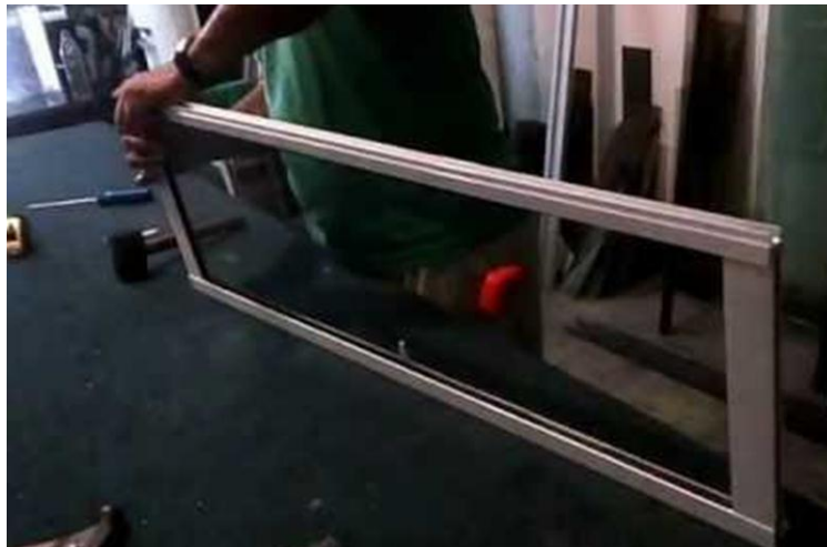
Figura 26: Ensamble del perfil de la hojas de la ventana con el vidrio
