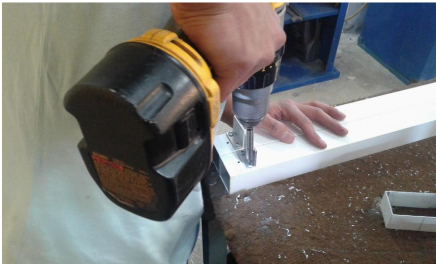
Figura 29: Colocación de anclas en el tubo
