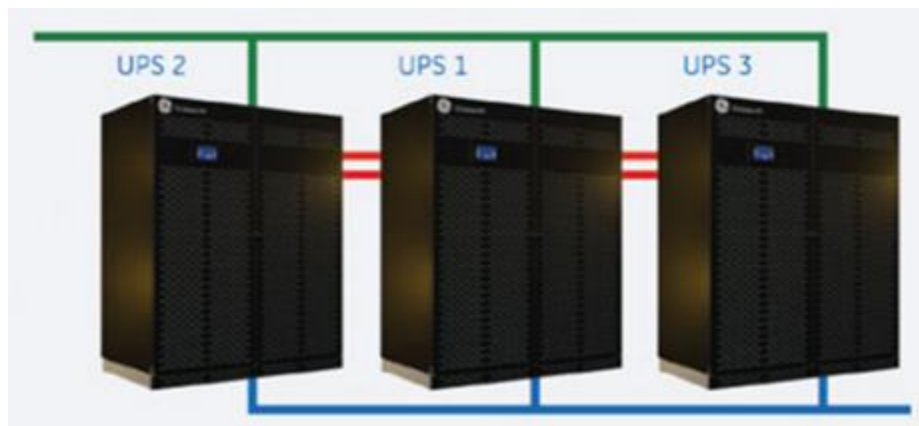
Figura 3.6: Sistema de UPS con redundancia.
