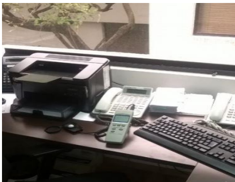
Figura 27. Medición de iluminación Dirección de seguridad. Tomado de: Empresa de seguridad.
