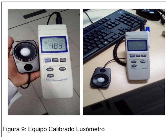
Figura 9: Equipo Calibrado Luxómetro
