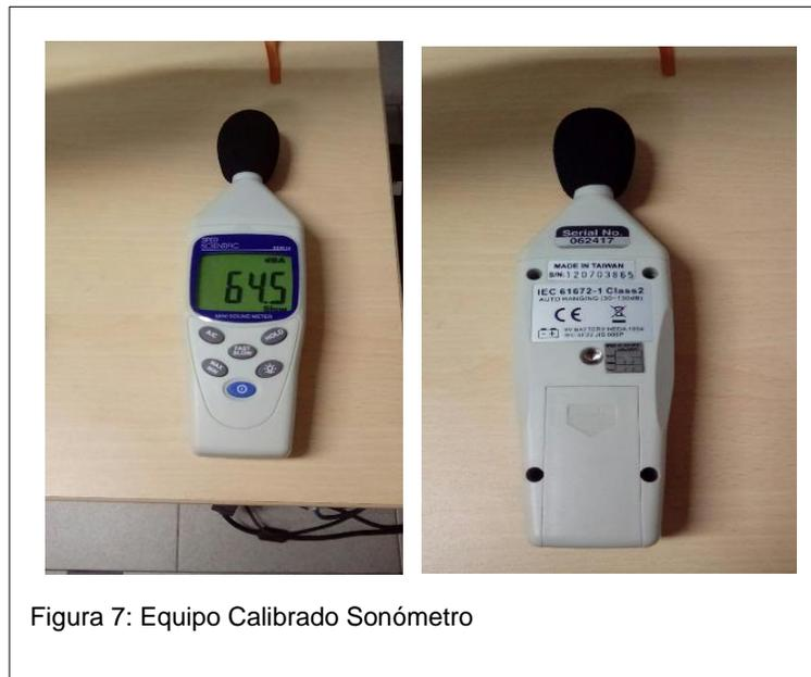
Se realizaron las mediciones del sonómetro y el celular para ingresar a la ecuación de regresión y obtener la calibración del equipo, los datos ingresados fueron los siguientes:
