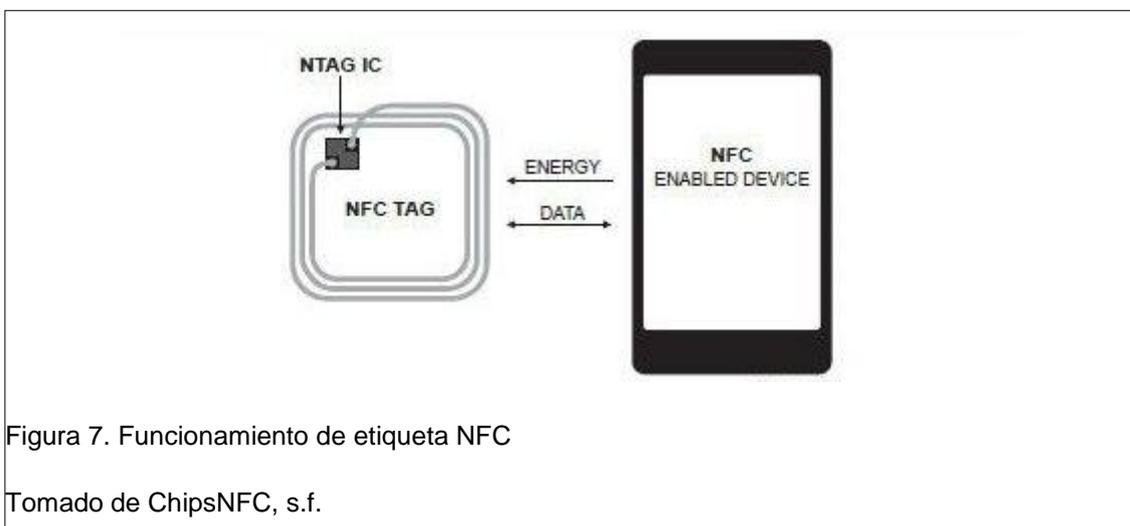
Su velocidad de transferencia depende del entorno en el que se trabaje o en el acuerdo de ambos dispositivos en la transferencia y varía entre 106, 212, 424 o 848 Kbits/s, siendo esta velocidad configurada en cualquier instante de la comunicación.
