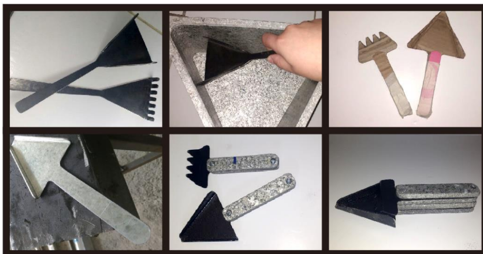
Figura 52. Proceso de construcción de herramientas: corte de piezas; doblez de plancha de acero galvanizado; lijado de bordes; ensamble con remaches de mango de polialuminio a parte metálica.
