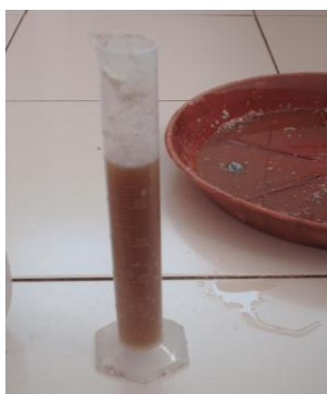
Toma de muestra de lixiviados
