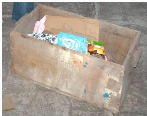
Prisma de madera para medición de volúmenes y pesaje de materiales para determinación de los pesos específicos.
