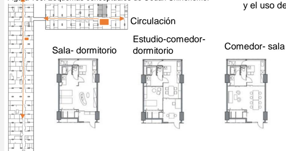
La unidad se resuelve mediante dos franjas, la primera con espacios servidores y servidos (cocina y comedor). La segunda más versátil con posibilidad de ampliación (dormitorio-sala). Y dos ejes de circulación permanente para permitir la circulación aún si el espacio varía de función
