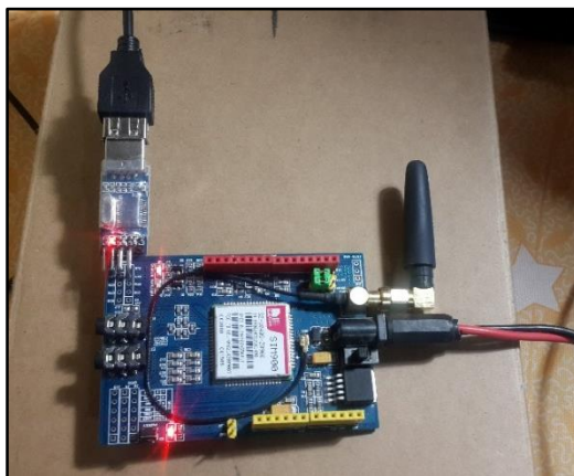
Figura 94. Conexiones del módulo GSM del servidor.
