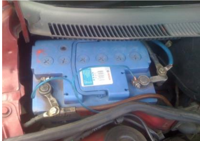
Figura 111. Alimentación eléctrica del circuito.
