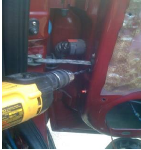
Figura 113. Instalación de sensores en las puertas.
