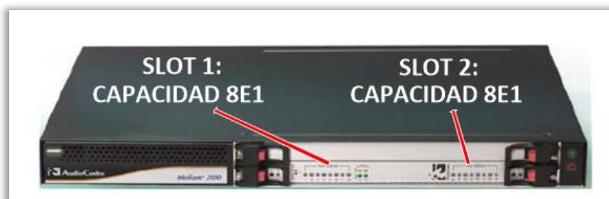
Figura 15. Puertos Equipo Media Gateway Mediant 2000 (M2K).
