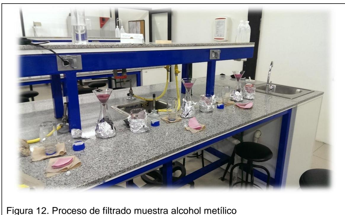
Figura 12. Proceso de filtrado muestra alcohol metílico
