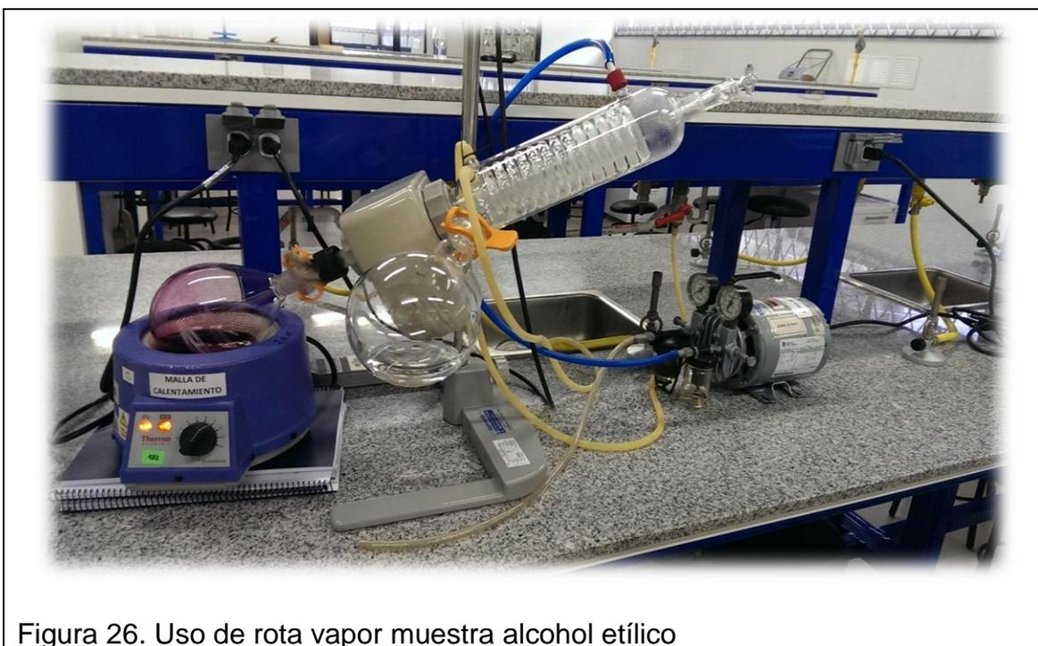
Figura 26. Uso de rota vapor muestra alcohol etílico
