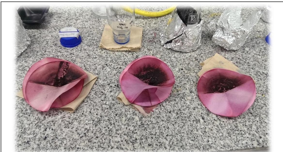
Figura 14. Filtros whatman después de filtrar muestra alcohol metílico
