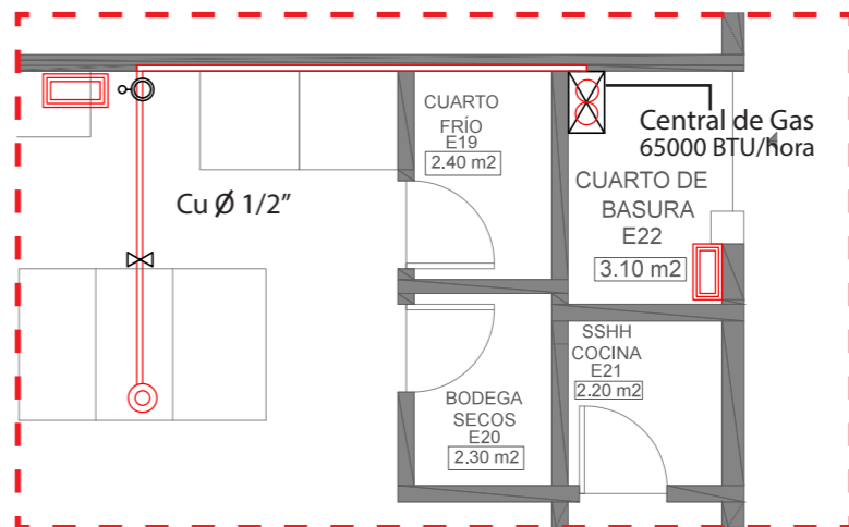
DETALLE DE CENTRAL DE GAS ESC. 1:75
