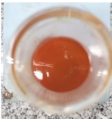
Figura 16. Precipitado ladrillo obtenida de la extracción de cloruros
