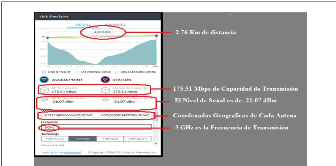
Figura 42. Simulación de estación Troncal
