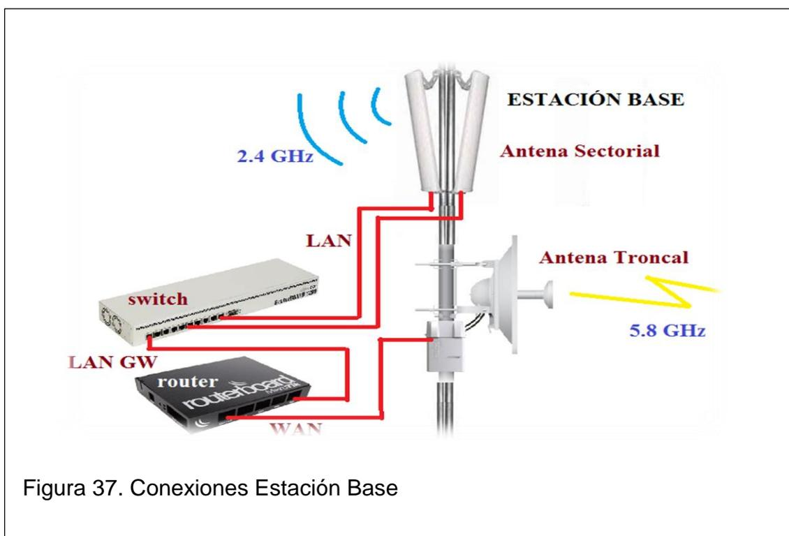
Figura 37. Conexiones Estación Base
