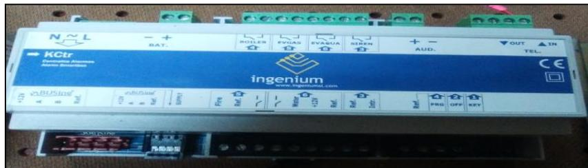
Figura 47. Central de alarmas técnicas KCtr
