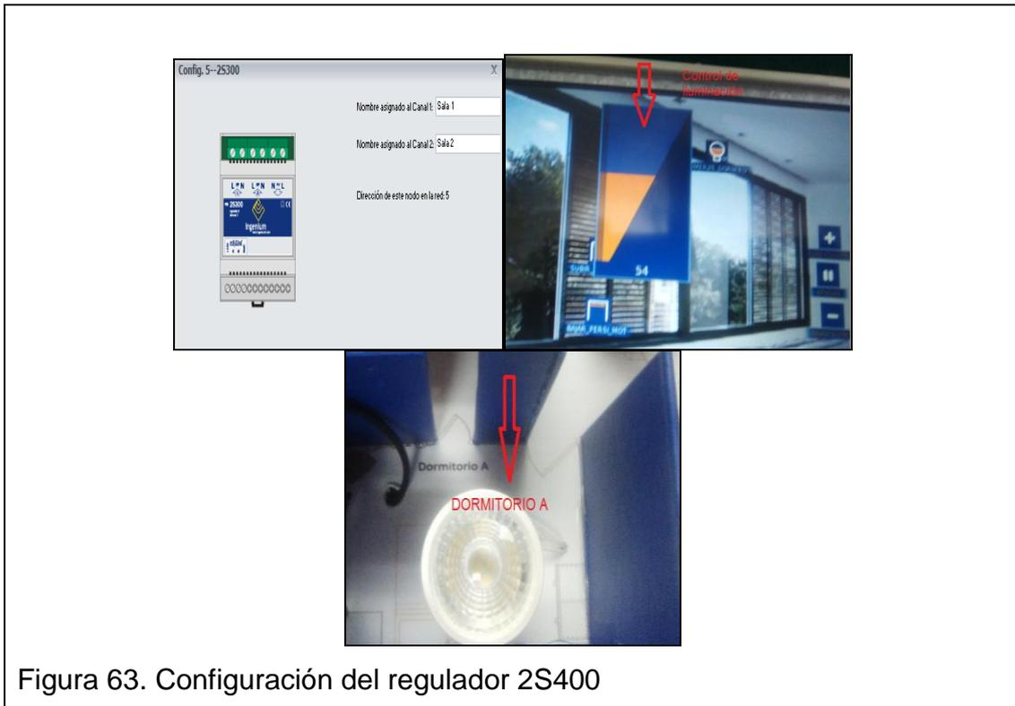
Figura 63. Configuración del regulador 2S400
