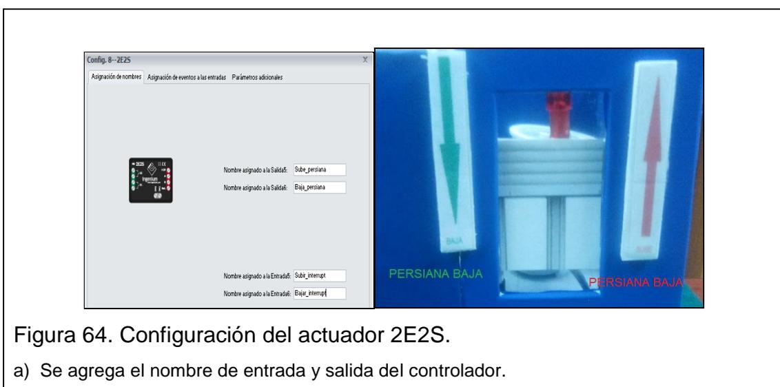
Figura 64. Configuración del actuador 2E2S.
